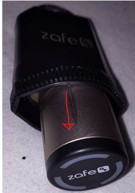
Figur 3: Træk let ned på låsen på hængelåsen medens du drejer den sølvfarvede del.
