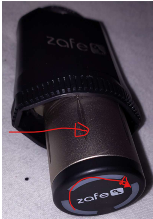
Figur 1: Man tager fat om den sølvfarvede del og drejer mod højre.
